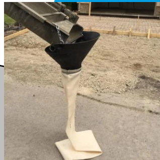
Mini Tremie Pipe & Hopper
